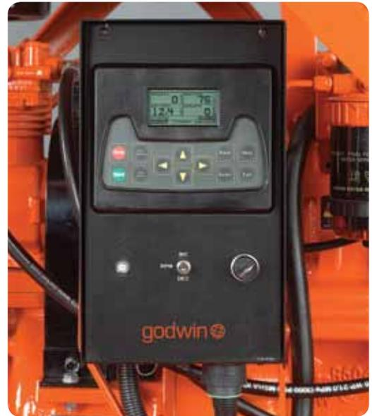
PrimeGuard puede obtenerse como opción en todas las series CD y HL de bombas Dri-Prime con motores diesel de una potencia superior a 140 kW.
